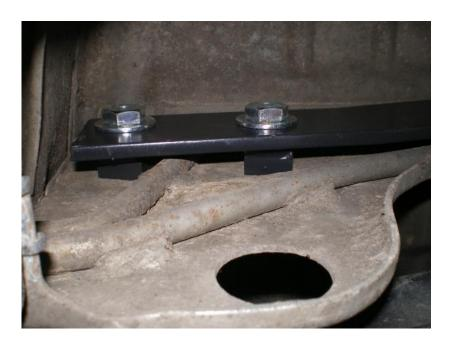
On utilise 1 écrou et une rondelle pour lier le renfort à la vis prisonnière du côté droit.
