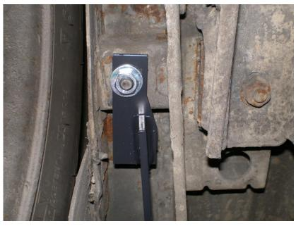
Pour le renfort du côté gauche, 2 vis, 2 écrous et 4 rondelles
