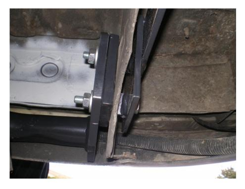
On utilise 1 écrou et une rondelle pour lier le renfort à la vis prisonnière du côté gauche.
